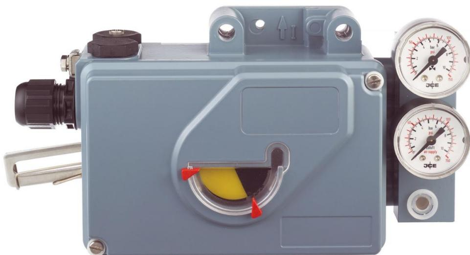
Analoge Stellungsregler SRI990 mit Analogeingang 4-20 mA ist entworfen, um pneumatische Ventile zu steuern. Sein Vorteil ist, einfach zu installieren mit Potentiometern und Schaltern. Der modulare Aufbau ermöglicht die einfache Konvertierung von analogen "intelligente" Geräte, die auf Elektronikausch.
