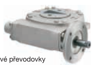
Kyvné servopohony AS 6 - AS 50 Krutici moment od 25 do 500 Nm Doby přestavení pro 90° od 4 do 90 s
