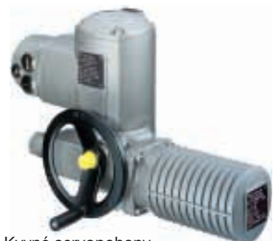
Kyvné servopohony SG 05.1 - SG 12.1 Krutici moment od 100 do 1 200 Nm Doby přestavení pro 90° od 4 do 180 s
