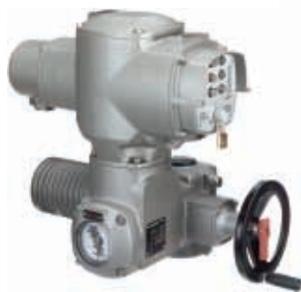
Ovládací jednotka AUMA MATIC s otočnými servopohony SA / SAR Krutici moment od 10 do 1 000 Nm Otáčky od 4 do 180 min -1
