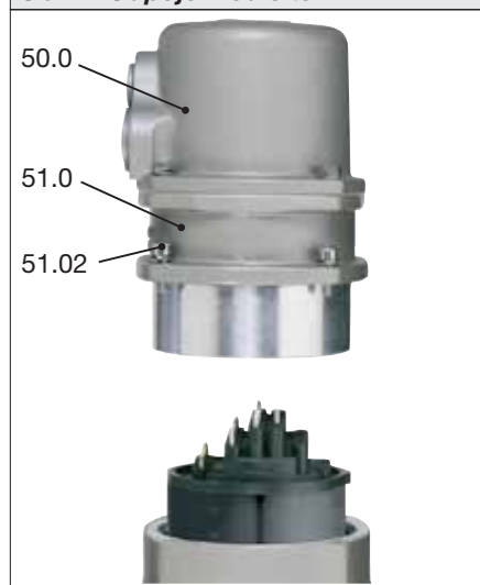
Obr. 4: Odpojení od sítě
